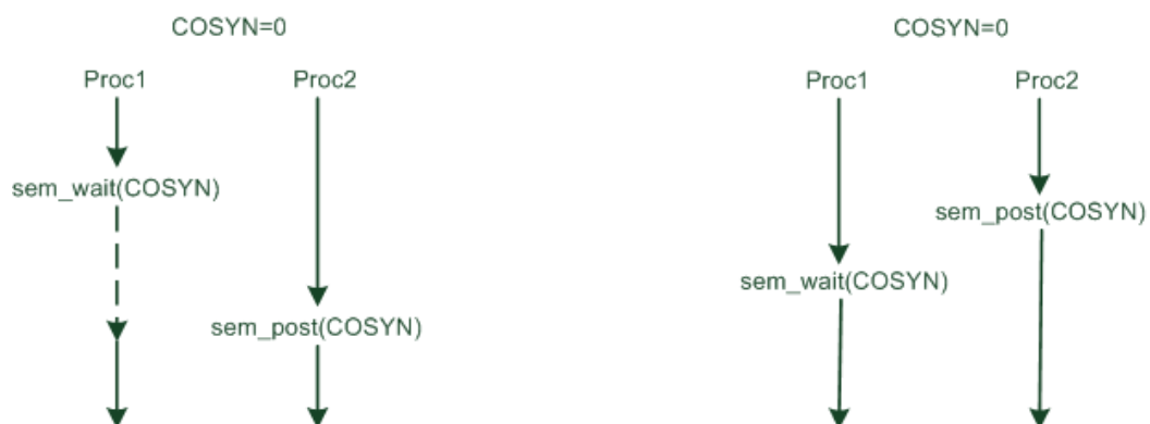
Rys. 3. Synchronizacja procesów z zastosowaniem semafora.
