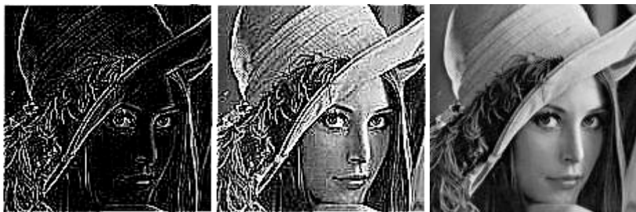
Rysunek 9.4.6.2-1. Powiększona fotografia twarzy: oryginalna oraz filtrowana górnoprzepustowo. Filtrowanie z punktem centralnym 8 pokazuje białe krawędzie na czarnym tle. Filtrowanie z punktem centralnym 9 wypukla szczegóły bez zaczerniania obrazu
