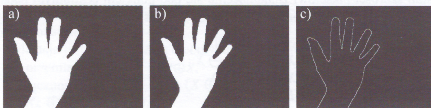
Rys. 5.5. Wyznaczanie brzegu wewnętrznego obiektu binarnego: a) obraz wejściowy, b) obraz zerodowany, c) brzeg wewnętrzny
